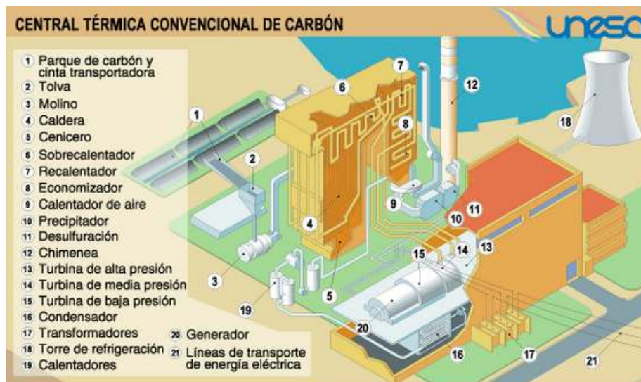
Ilustración 3 Central térmica convencional de carbón
