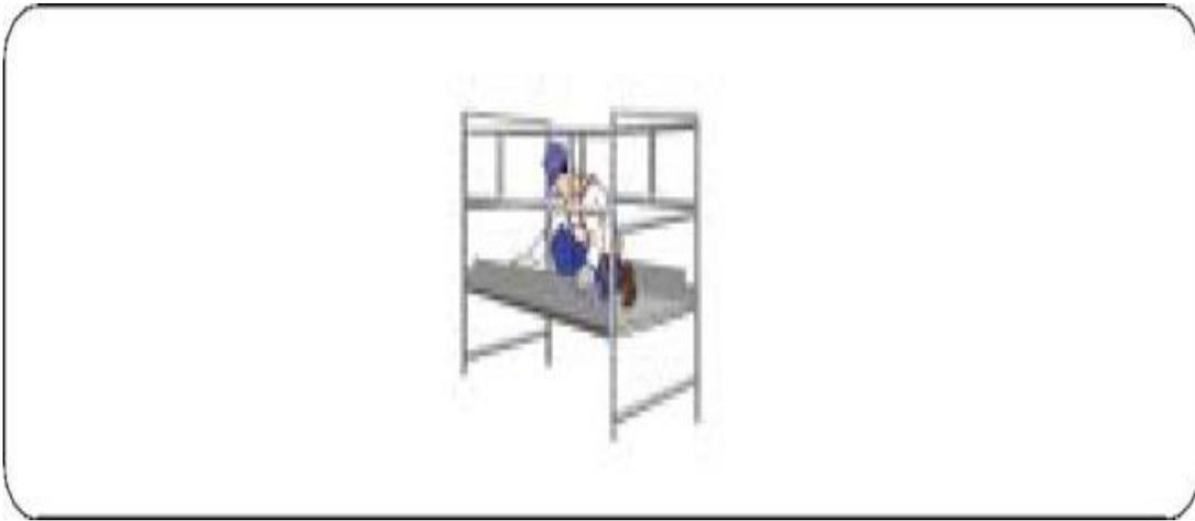
**Figura 26.** Instalación de rodapiés y plataformas
