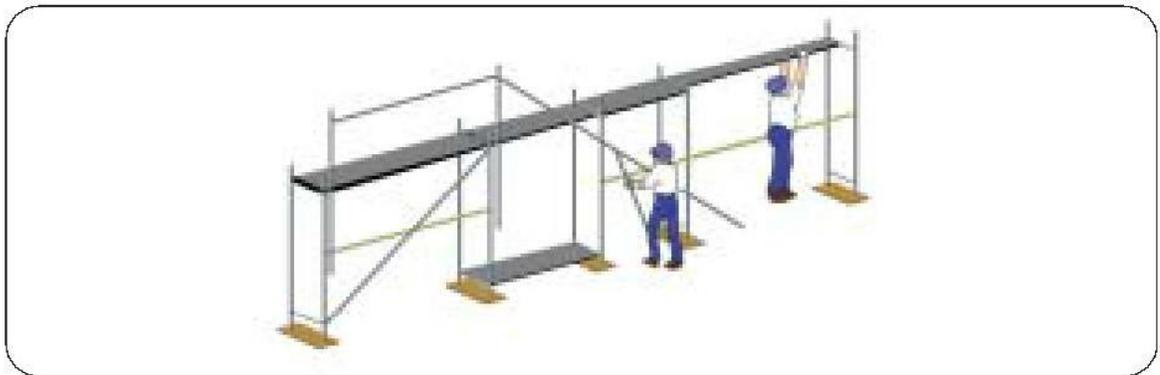
**Figura 17.** Colocación de soportes-barandillas.
