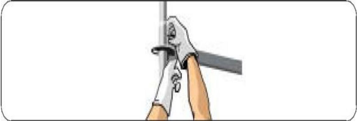
**Figura 37.** Desmontaje de travesaños
