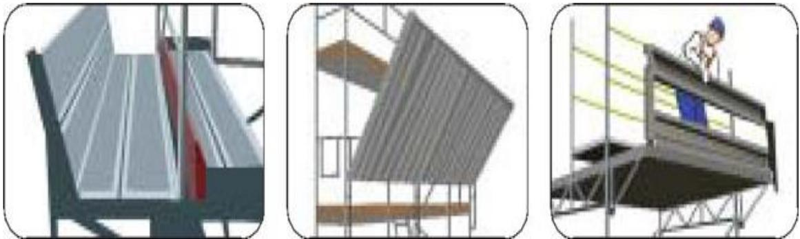
**Figura 39.** Plataformas inclinadas, tapajuntas.
