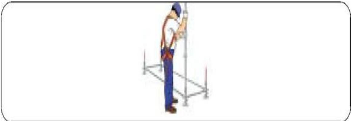
**Figura 38.** Desmontaje de verticales
