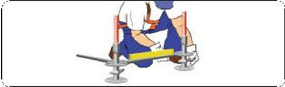
**Figura 22.** Instalación de bases y copas.
