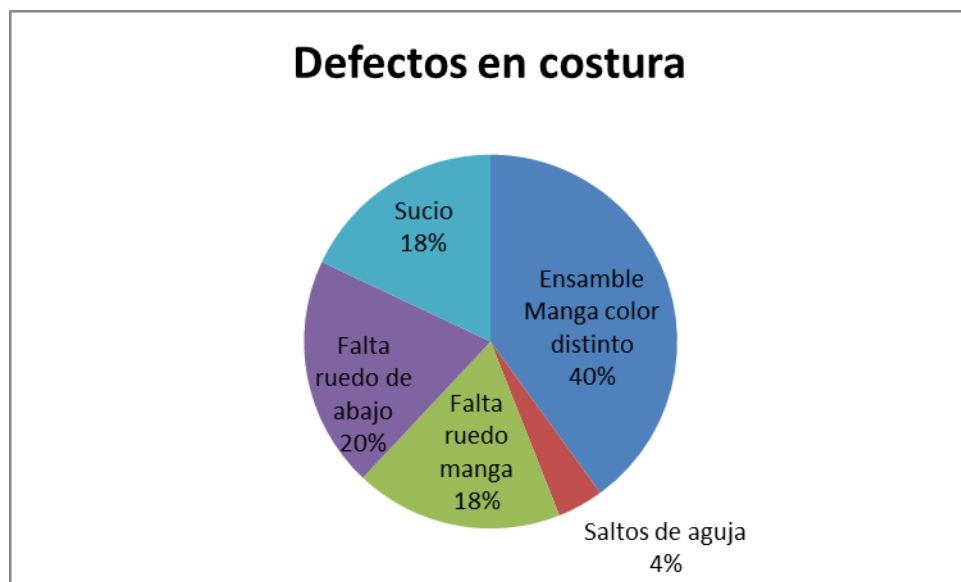
Figura 8. Defectos en costura Fuente: propia
