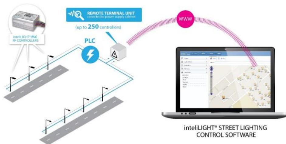
**Figura 13.** Sistema de telegestión con comunicación vía Onda portadora (PLC). (Intelilight, 2014)
