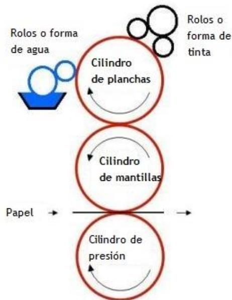
Figura No, 1 *Esquema de un cuerpo impresor offset*
