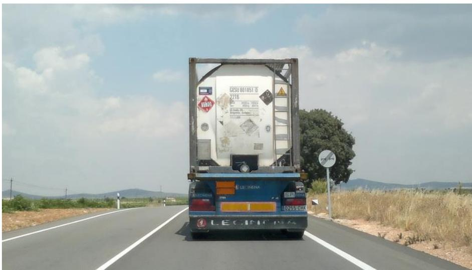
Iso tanque con Alcohol debidamente identificado.
