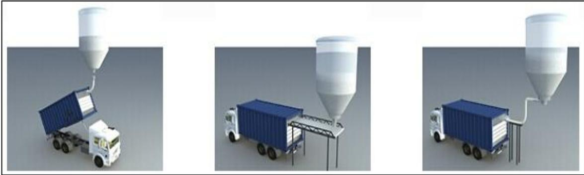
**Figura 12.** Utilización de tolva para carga a granel
