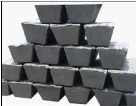
**Figura 1.** Lingote de ferroníquel.
