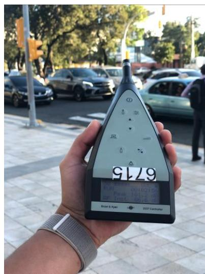
**Figura 36.** Medidor de sonido
