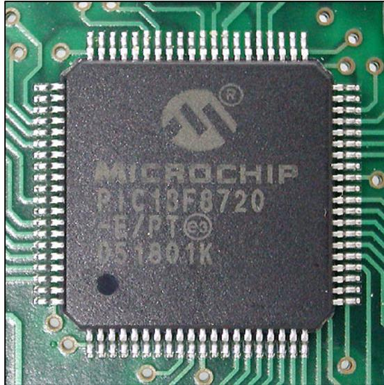
*Figura 45. Microcontrolador Microchip PIC18F8720 en encapsulado de 80 pines
