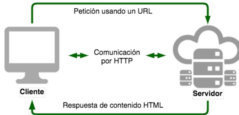
Figura 30. Diagrama de la interacción cliente-servidor vía http
