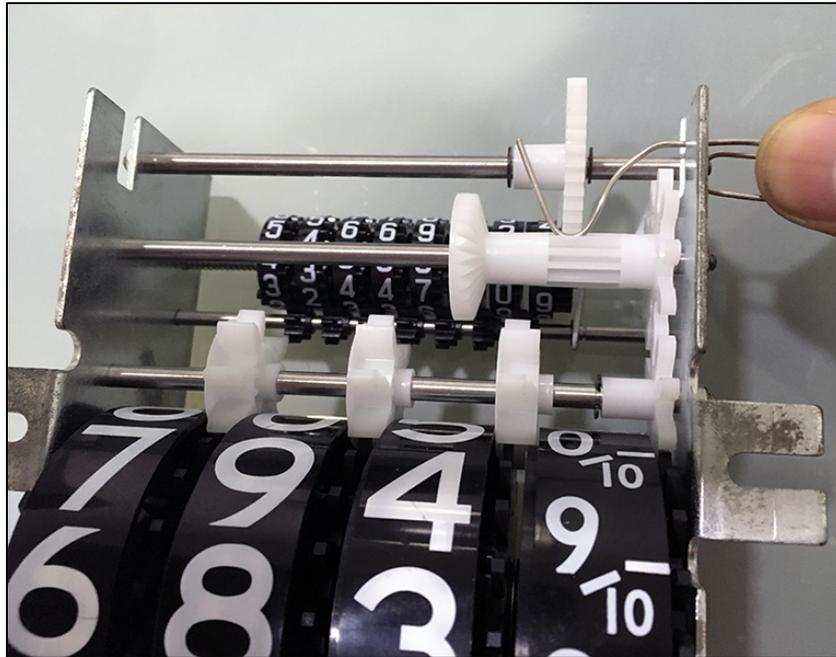
Figura 85. Demostración de la deshabilitación de un contador mecánico.
