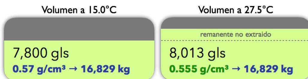
*Figura 88. Cambio de densidad debido al cambio de temperatura.
