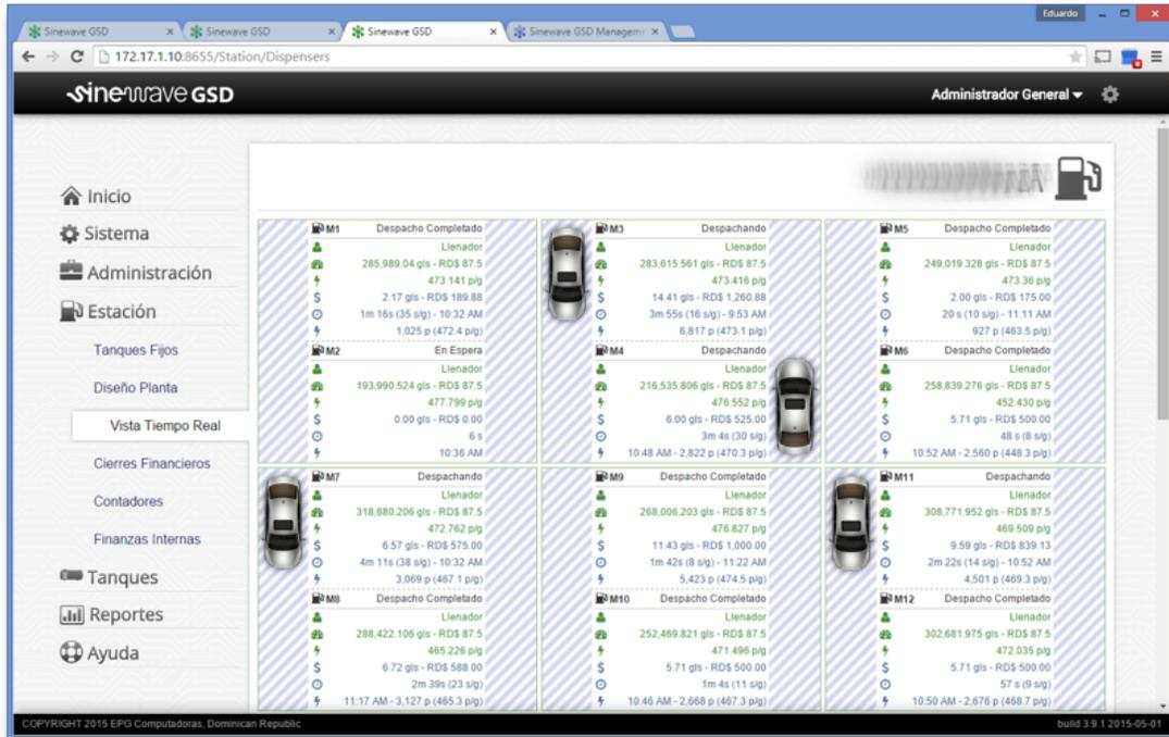
Figura 130. Pantalla para seguimiento de despachos en tiempo real en GSD Gateway
