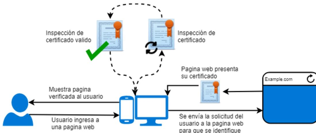
Figura 30: Funcionamiento del certificado TLS.
