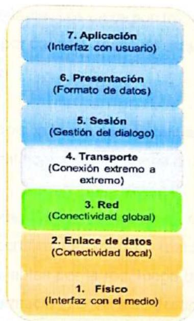
**Ilustración 3.** El modelo de referencia OSI y sus capas de arquitectura.
