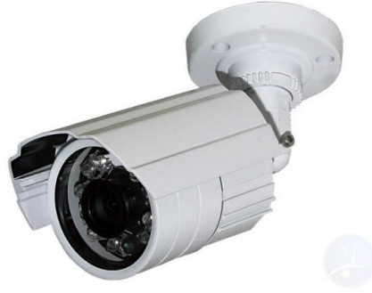
Figura 3.4. Cámara tipo bala
