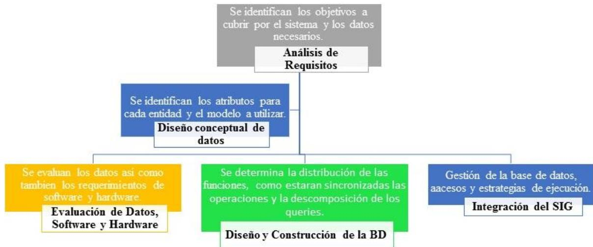
Figura 3. Fases de Diseño de Sistemas.
