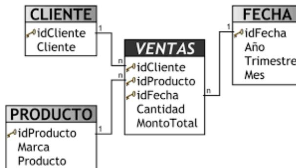
**Figura 14.** Esquema de un Modelo de DB Lógico.
