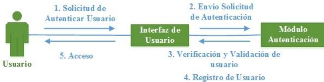
Figura 62. Diagrama de colaboración autenticación.
