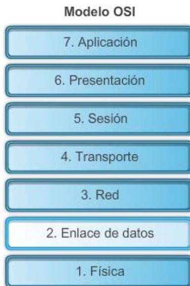
**Figura 2. Capas del modelo OSI**
