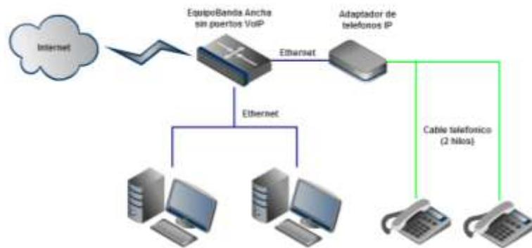
**Figura 22 - Esquema VoIP con ATA**
