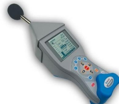
*Figura 7. Medidor de parámetros microclimáticos MI 6201 METREL (Análisis de calidad de la energía, p.208, 2012).*
