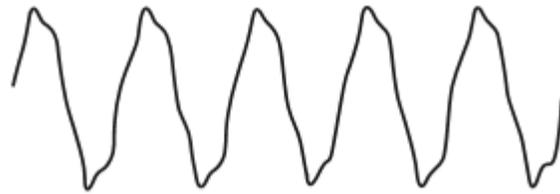
Figura 3. Representación de 5to armónico (Análisis de calidad de energía, p.161, 2012).
