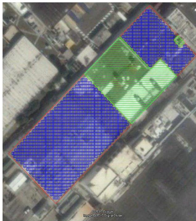
Figura 16. Diseño de paneles fotovoltaicos. Fuente: Google Earth.
