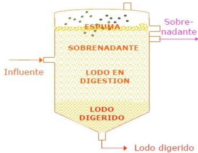
**Figura 6.** Digestores De Mezcla Completa (A). [30]
