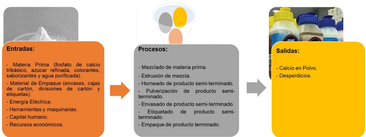
**Figura 7. Esquema de los elementos del Proceso de Elaboración de Calcio en Polvo.**
