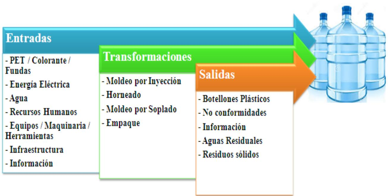
**Figura 6: Elementos del Proceso de Elaboración de Botellones Plásticos.**
