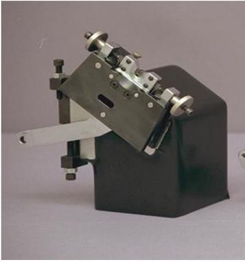
**Ilustración 56. Máquina de fijación de agujas e hilo**
