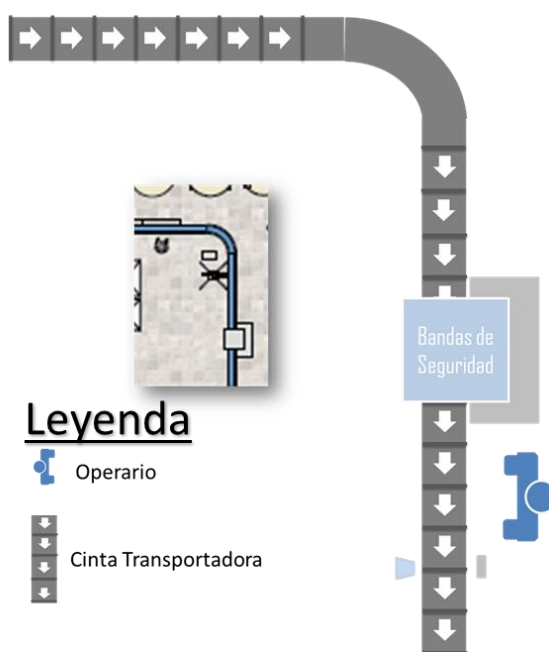
Ilustración 19-Inspección Banda de Seguridad
