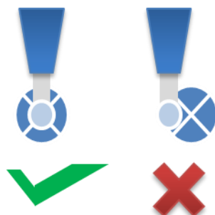
Ilustración 17-Posición Correcta de las Boquillas en Relación al Botellón
