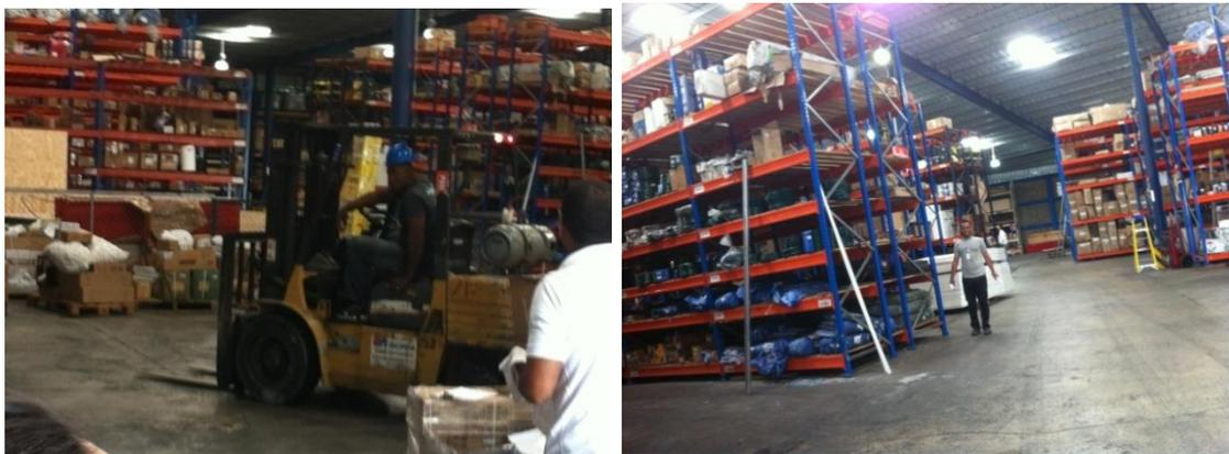
**Figura 9: Vías de Circulación sin Señalización en el Almacén Techado.**
