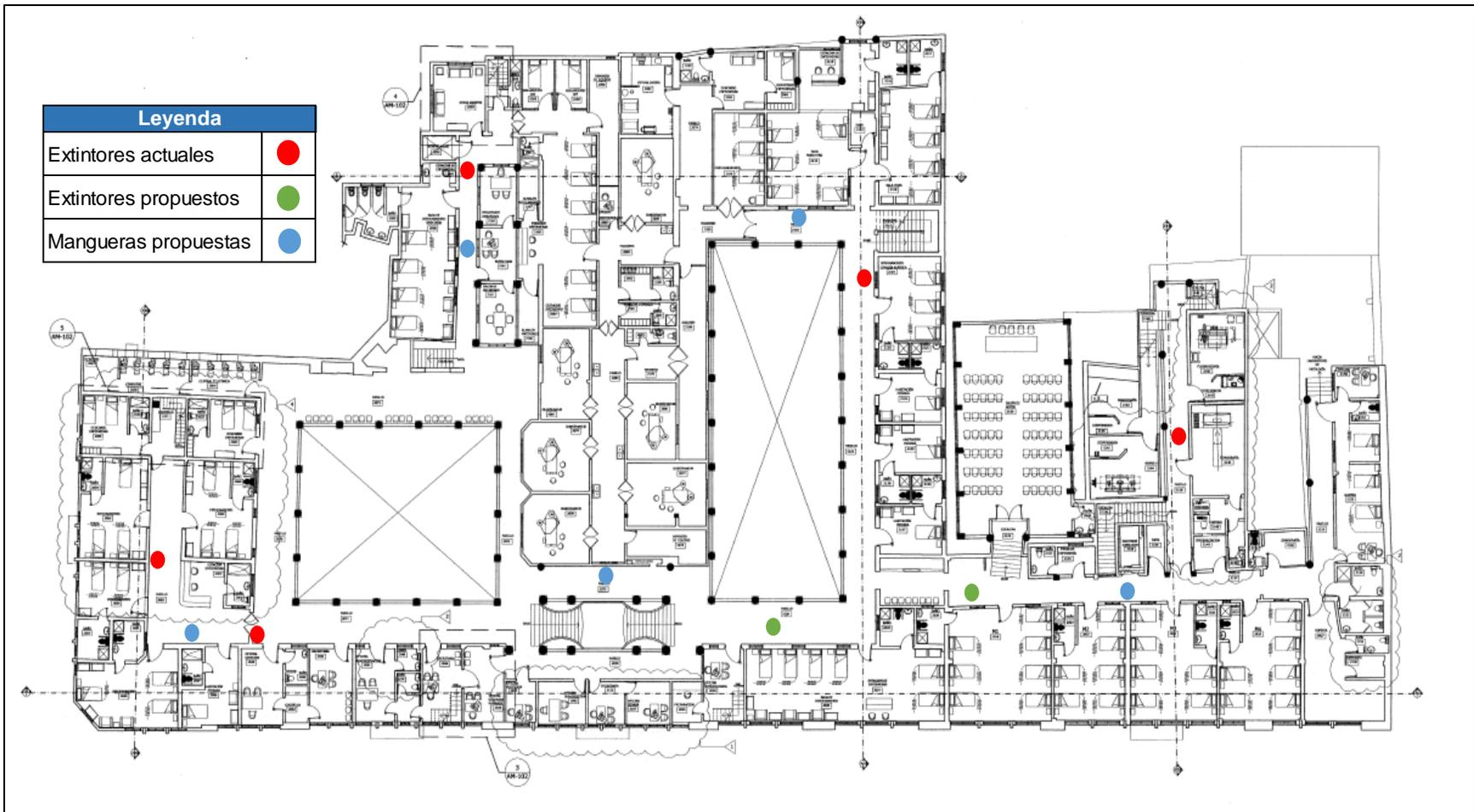
Figura XXVII. Ubicación de mangueras propuestas, extintores actuales y propuestos en el segundo nivel
