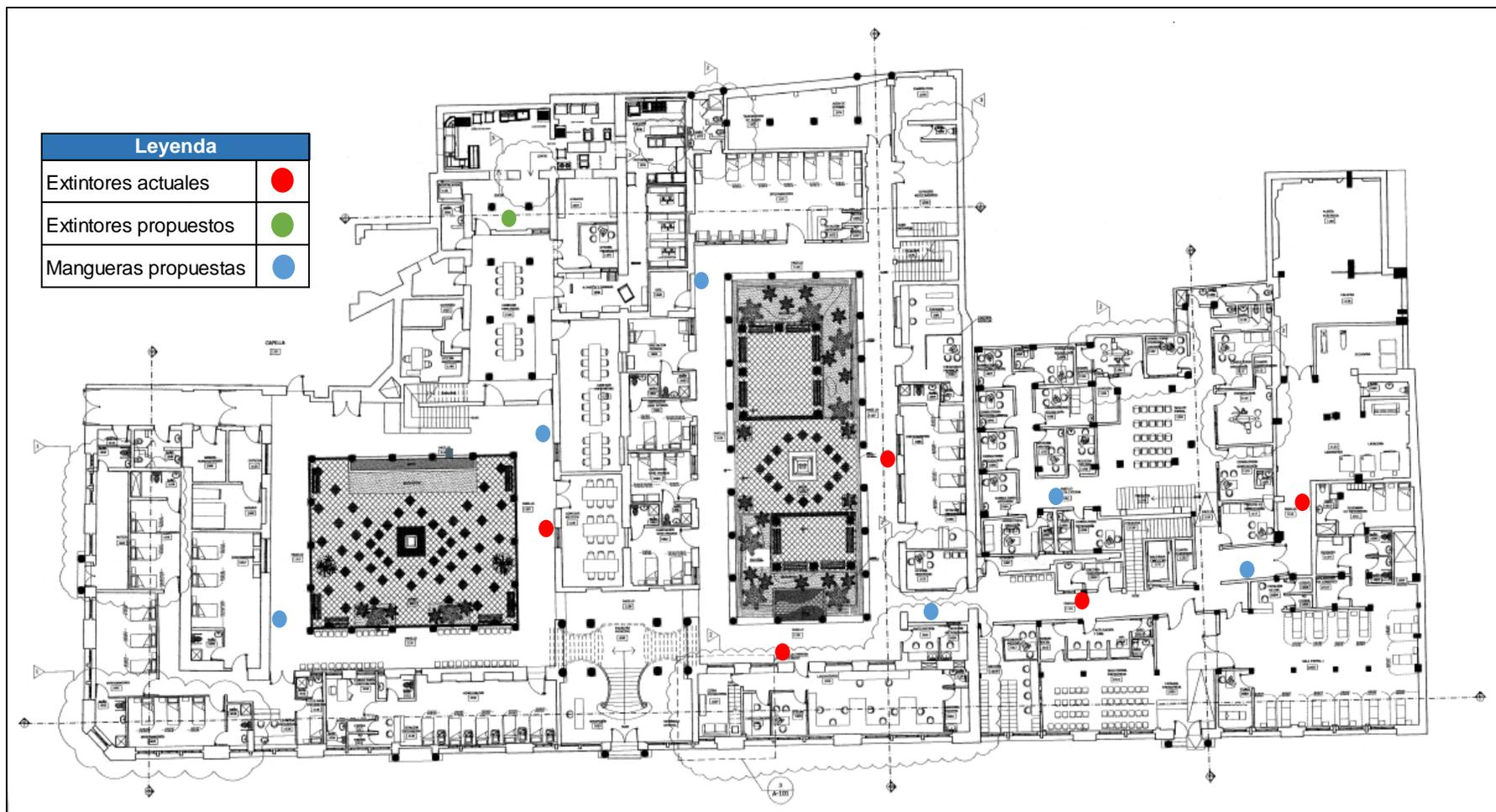
Figura XXVI. Ubicación de mangueras propuestas, extintores actuales y propuestos en el primer nivel
