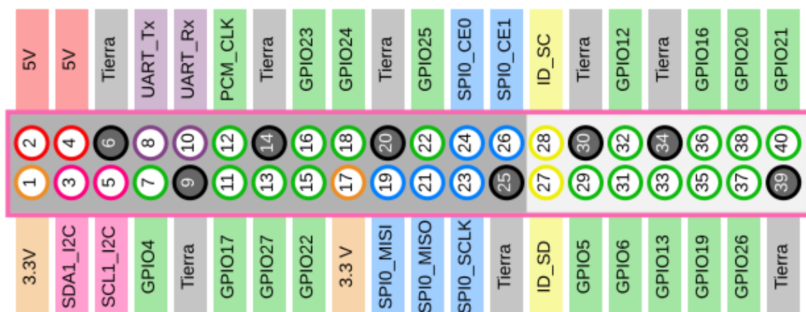
Figura C.3. Disposición de pines de la Raspberry Pi 2 Modelo B V1.1. 135
