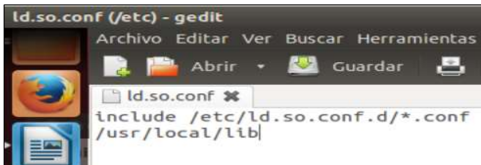
Figura 15. Modificación del archivo ld.so.conf para poder hacer la configuración de GNU radio.
