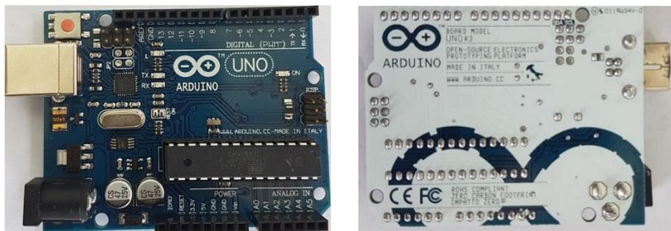
**Figura 11:** Parte superior (izquierda) e inferior (derecha) de la placa Arduino UNO con el microcontrolador ATMEGA como cerebro de la plataforma.
