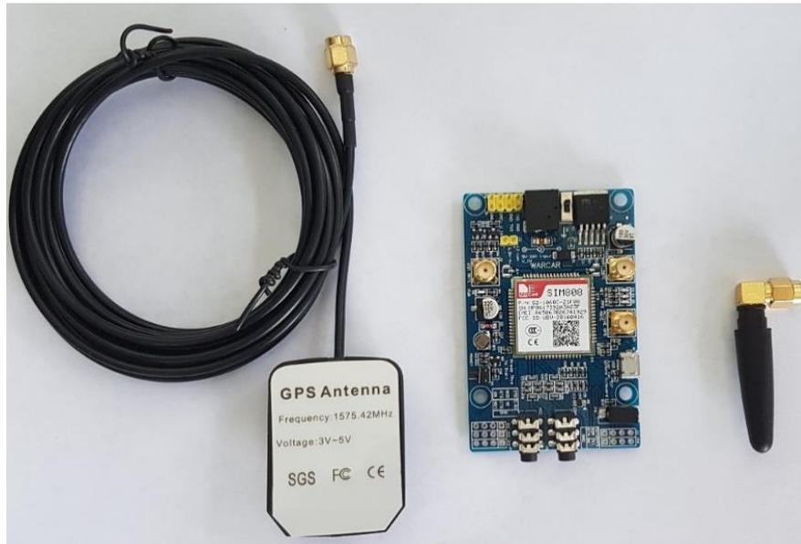
**Figura 13:** Parte superior del módulo SIM808, GPS-GSM, con sus respectivas antenas.
