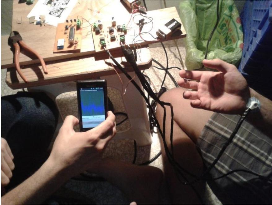
**Figura 2.13: El prototipo del sistema de monitoreo de parámetros cardiacos registrando la señal de ECG y desplegándola en la aplicación móvil.**
