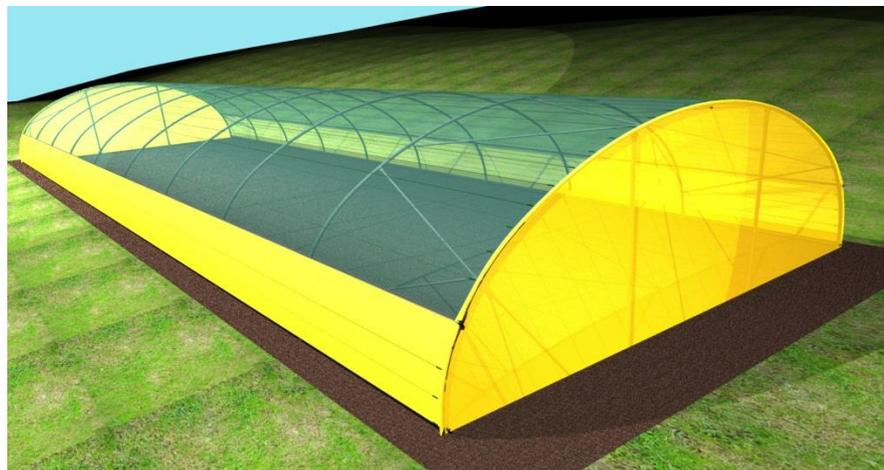
**Figura 3.** Tipos de invernaderos. (a) Invernadero capilla. (b) Invernadero túnel.
