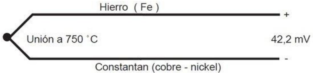
**Figura 5.** Termopar creado con un conductor de Hierro y otro de Constantan (aleación entre Cobre y Níquel).
