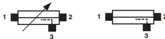
Figura 1.4. Tipos de Taps. (Fuente: Tolstrup, 2008)
