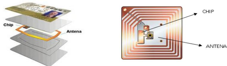
Ilustración 13 - Etiquetas RFID pasivas. La izquierda representa una tarjeta de PVC con la incorporación en su interior de una antena y chip. La de la izquierda es un tag adhesivo.
