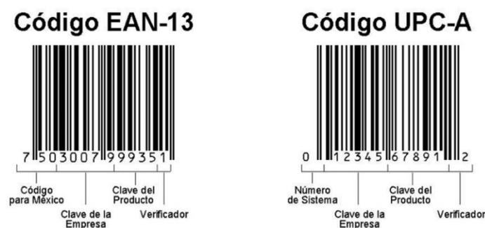
Figura 1 - Simbología de los Códigos de Barras EAN y UPC. Fuente: Tec Electrónica
