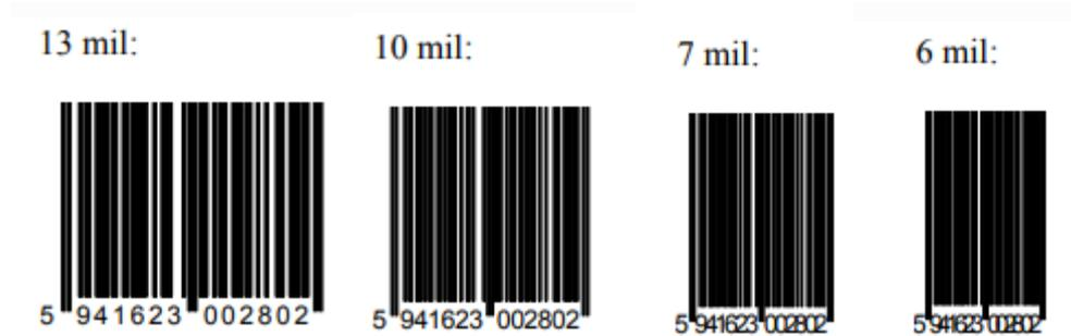
Figura 2 - Comparación de un código de barras en 13 MIL, 10 MIL, 7MIL y 6 MIL. Fuente: Honeywell
