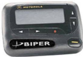
Un radiolocalizador es un dispositivo de comunicación personal. Los radiolocalizadores se clasifican con base en la forma como se comunican:
