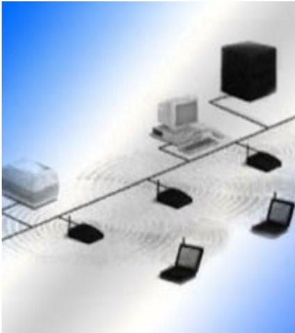
Una red de computadoras local inalámbrica es un sistema de comunicación de datos que utiliza tecnología de radiofrecuencia. En esta red se transmite y recibe datos sobre aire, minimizando la necesidad de conexiones alámbricas, es decir, combinan la conectividad de datos con la movilidad de usuarios.
