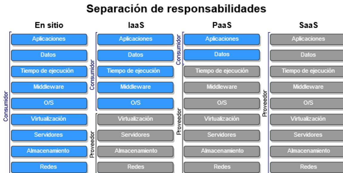
**Figura N° 2.** Diagrama de la Arquitectura de la Pila de Servicios del “Cloud Computing”
