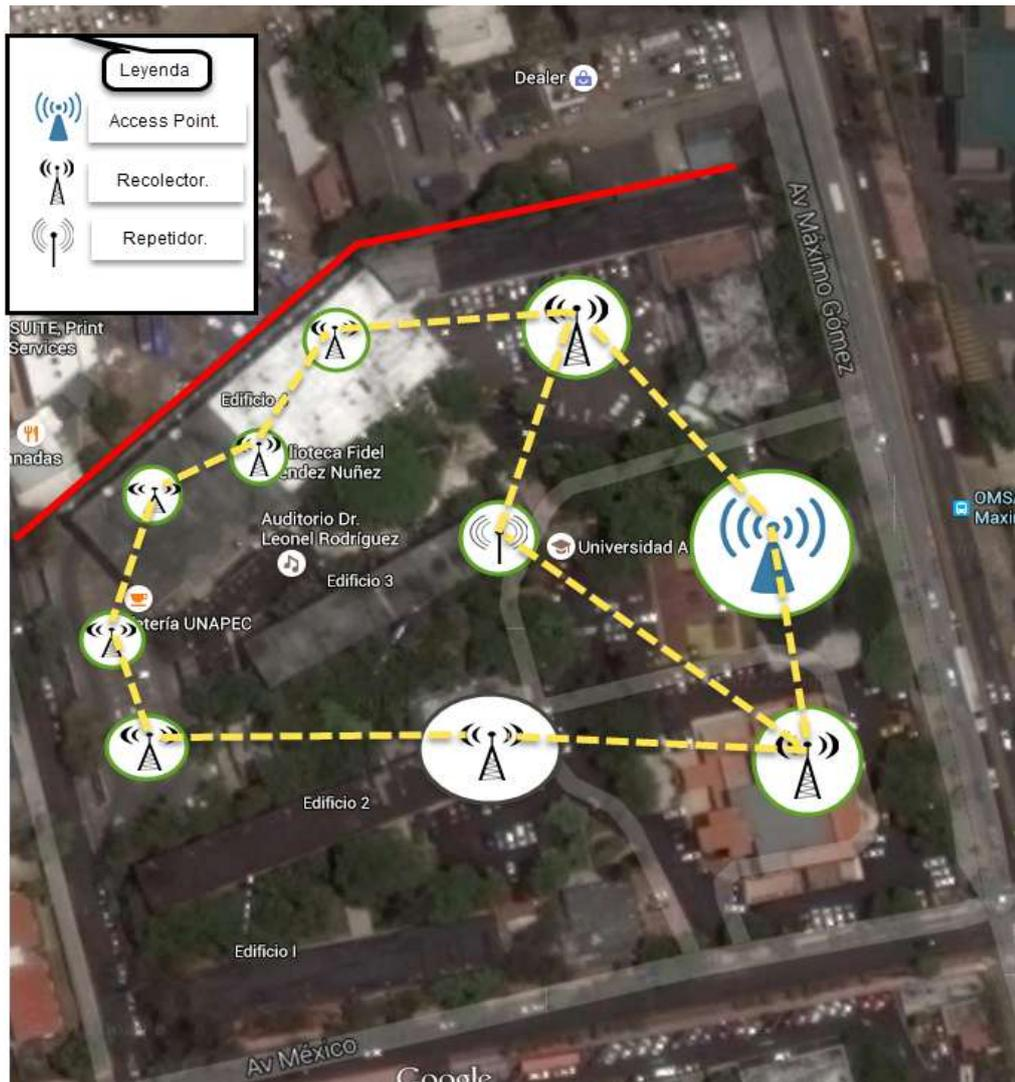
Figura 6.24: Esquema general de red inalámbrica ©E.F (2015)
