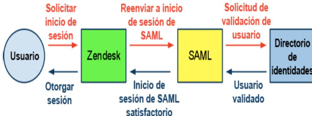
Ilustración 18. Diagrama ejemplo de aplicación "Autenticación de usuario " con estándar SAML en plataforma Zendesk
