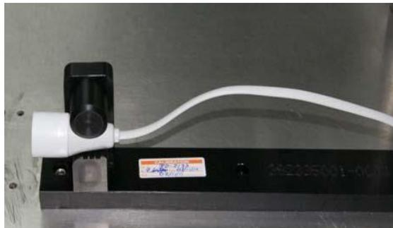
**Sujetador de cable, Fig.9**
