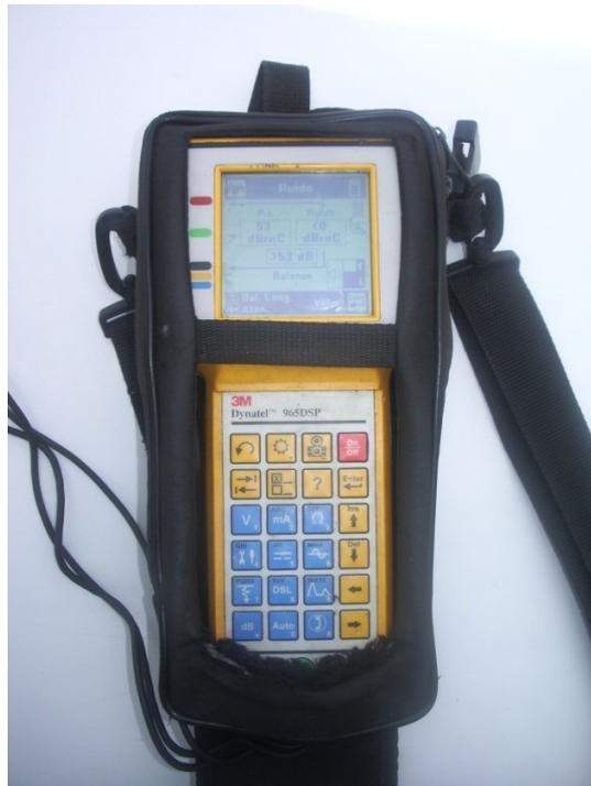
**TDR 3M Dynatel 965DSP utilizado en la empresa de telecomunicaciones CODETEL, para pruebas y análisis de cables de par trenzado**
