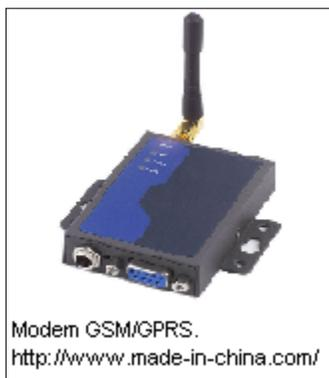
GPRS se puede utilizar como portador de SMS. Si se usa SMS a través de GPRS, se obtiene una velocidad de transmisión de SMS de alrededor de 30 mensajes SMS por minuto. Esto es mucho más rápido que el normal uso de SMS a través del GSM. Se requiere un módem GPRS para enviar y recibir SMS a través de GPRS. Sin embargo, hay que notara
