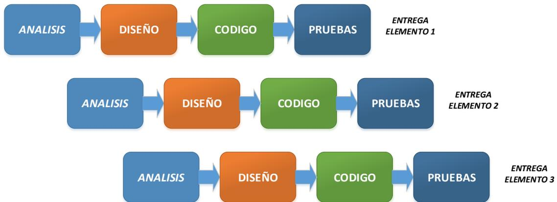
Figura 4.2 Modelo incremental. En este modelo se realizan varias iteraciones que generan un sistema funcional.
